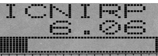
El SPECTRAN® indica el porcentaje alcanzado de un valor límite con un número decimal y lo representa gráficamente con una barra
