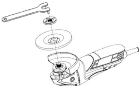
5. Presione y mantenga apretado el botón de traba, inserte la tuerca prensa disco y apriétela con firmeza usando la llave provista en dirección a las agujas del reloj. No la apriete demasiado.
