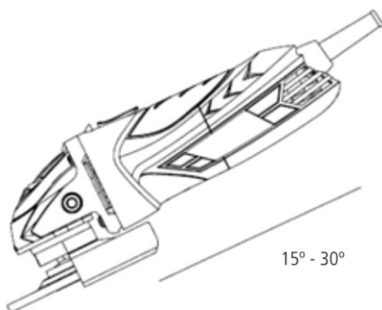
4. Mueva el disco hacia delante y hacia atrás o hacia arriba y hacia abajo sobre el área a desbastar.
